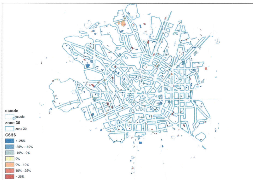
Figura 6.15 Mappa della variazione di esposizione al traffico di prossimità della popolazione scolastica di Milano per le emissioni di Benzene prodotte entro una distanza di 75 metri dagli edifici scolastici: confronto all'anno 2013 tra Stato di Fatto e scenario Zone 30
