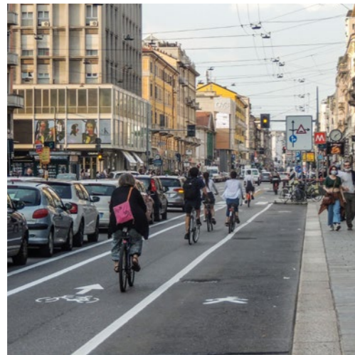
strumenti: buffer in segnaletica tipo: pittogramma larghezza minima: 0.9m
