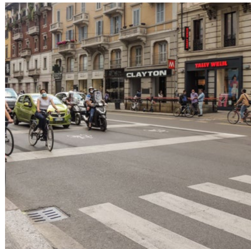
casa avanzata (pista ciclabile in corsia riservata tracciata in carreggiata) intersezione semaforizzata
